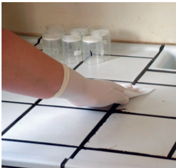
Dörzsmintavétel és mérés gyakorlása a hazai támogatóprogram keretében végzett NAÜ-tanfolyamon.
