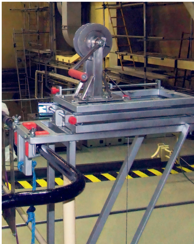
A hordozható kiegészített fűtőelem attribútum tesztet felfüggesztő-pozicionáló asztala, felszerelve az átrakógép korlátjára
